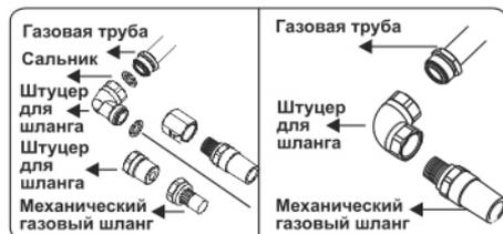
Помните, что данный прибор полностью укомплектован для подключения к газораспределительной системе только той страны, в которой он был изготовлен. Основная страна назначения указана на тыльной панели прибора. В случае установки прибора в другой стране может понадобиться какой-нибудь из приведенных типов присоединения на рисунке ниже. В этом случае свяжитесь с местными властями, чтобы узнать, как осуществить подключение к сети газоснабжения.
