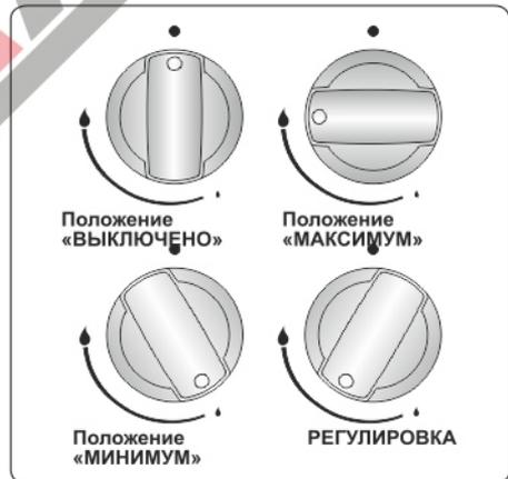
После зажигания визуально проверьте пламя. Если вы видите пламя с желтым верхом, приподнятое или неустойчивое пламя, выключите подачу газа и проверьте сборку крышек и насадок конфорок после их охлаждения. Убедитесь в отсутствии жидкости в крышках горелок. Если пламя горелки погасло, выключите горелку, проветрите кухню и повторно зажгите горелку через 90 секунд.
