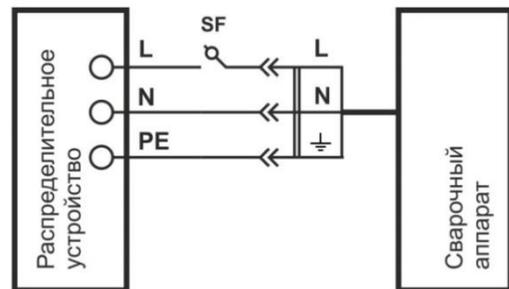
**Примечание:** символ  $\perp$  – обозначение провода заземления. Данный провод имеет желто-зеленую маркировку изоляции.
