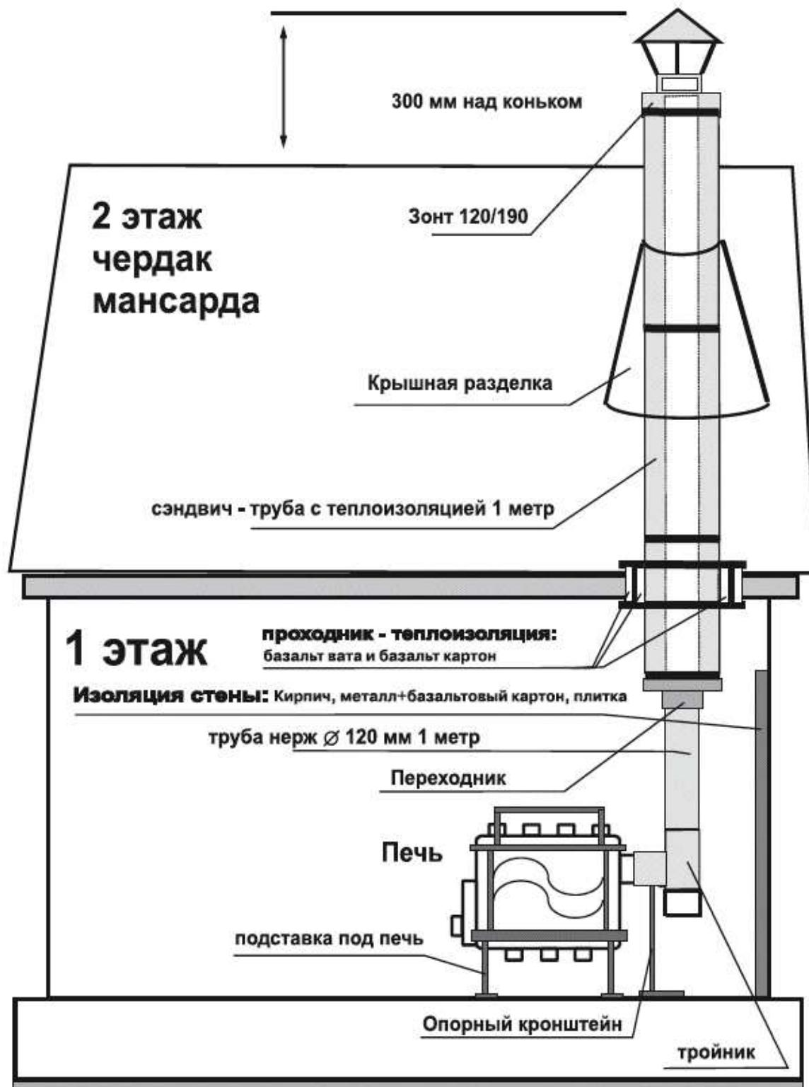
УСТАНОВКА ПЕЧИ С МЕТАЛЛИЧЕСКИМ ДЫМОХОДОМ (СЭНДВИЧ)
