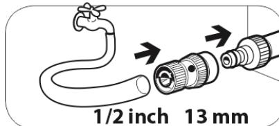
Длина шланга должна быть не менее 10 м для сглаживания возможных гидравлических ударов и не более 25 м. Ограничение по максимальной длине шланга связано с возможным падением давления воды в шланге и завоздушиванием системы.
