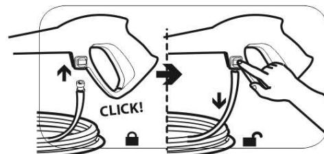
началом работы с мойкой убедитесь, что высоконапорный шланг полностью размотан и не имеет петель по всей длине. Следите, чтобы во время работы мойки высоконапорный шланг не образовывал петли. Это может сказаться на результатах работы при использовании мойки.
