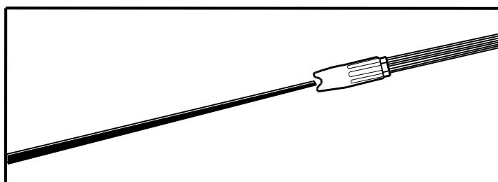
Узкая струя имеет максимальное давление на очищаемую поверхность, накрывает небольшие локальные участки и позволяет очищать поверхность на максимальную глубину.
