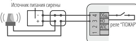
**Вариант 4:** Извещатель "ДОКА - а" подключается в нормально разомкнутый шлейф любой автоматики (ПКП, система "Умный дом", GSM сигнализация и т.п.), которая исполняет функцию оповещения о пожаре. "ДОКА - а" переходит в состояние "Пожар" и замыкает нормально разомкнутый шлейф. По сигналу от шлейфа автоматика исполняет оповещение о пожаре. Напряжение в шлейфе не должно превышать 24 В.
