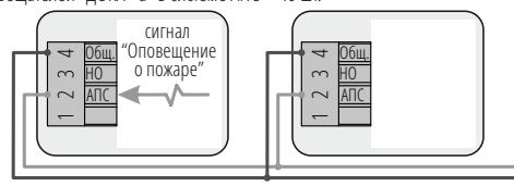
**Вариант 3:** Устанавливается один извещатель "ДОКА - а" и любой оповещатель (сирена) со своим источником питания. "ДОКА - а" переходит в состояние "Пожар" и замыкает встроенным реле "Пожар" миниусовую цепь питания сирены. Сирена должна работать от напряжения не более 24 В и потреблять не более 300 мА постоянного тока.
