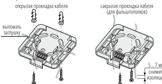
Для подключения отсоедините мульти-разъем как указано на рисунке. Подключите провода согласно схеме при помощи отвертки.
