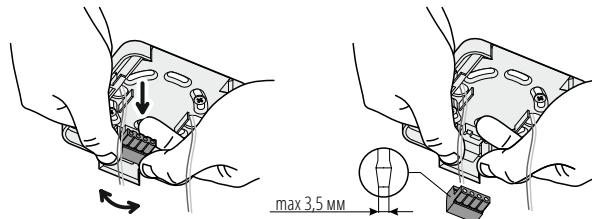
Вставьте мульти-разъем обратно в базу. Уложите провода под фиксаторы.
