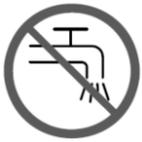
Согласно действующим предписаниям устройство запрещается подключать непосредственно к коммунальной хозяйственно-питьевой системе без системного разделителя в трубопроводе. Убедитесь, что подключение к домашней сети водопровода, к которому подсоединен моечный аппарат высокого давления, оснащено обратным клапаном в соответствии с EN 12729, тип ВА. Вода, прошедшая через системный разделитель, считается непригодной для питья.
