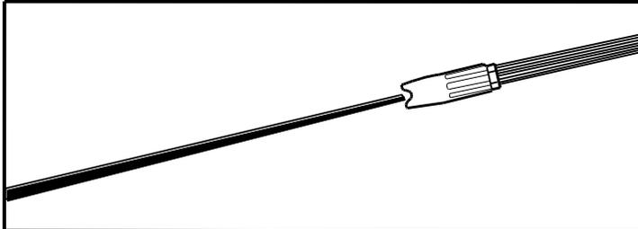
Узкая струя имеет максимальное давление на очищаемую поверхность, покрывает небольшие локальные участки и позволяет очищать поверхность на максимальную глубину.
