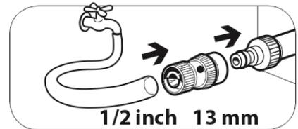
Длина шланга должна быть не менее 10 м для сглаживания возможных гидравлических ударов и не более 25 м. Ограничение по максимальной длине шланга связано с возможным падением давления воды в шланге и завоздушиванием системы.
