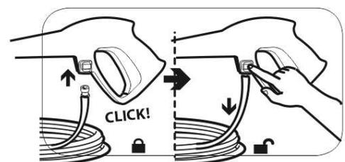
Ниппель высоконапорного шланга вставьте до щелчка в быстросъемное гнездо рукоятки моечного пистолета. Перед началом работы с мойкой убедитесь, что высоконапорный шланг полностью размотан и не имеет петель по всей длине. Следите, чтобы во время работы мойки высоконапорный шланг не образовывал петли. Это может сказаться на результатах работы при использовании мойки.
