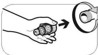
На резьбу входного патрубка с **лицевой стороны** корпуса мойки прикрутите фильтр тонкой очистки с ниппелем быстросъемного соединителя.
